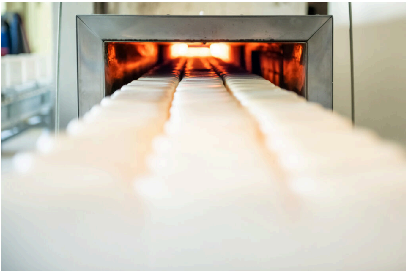
Glühofen in der Produktion der Leuchtstoffwerk Breitungen GmbH Bildquelle: Leuchtstoffwerk Breitungen GmbH
