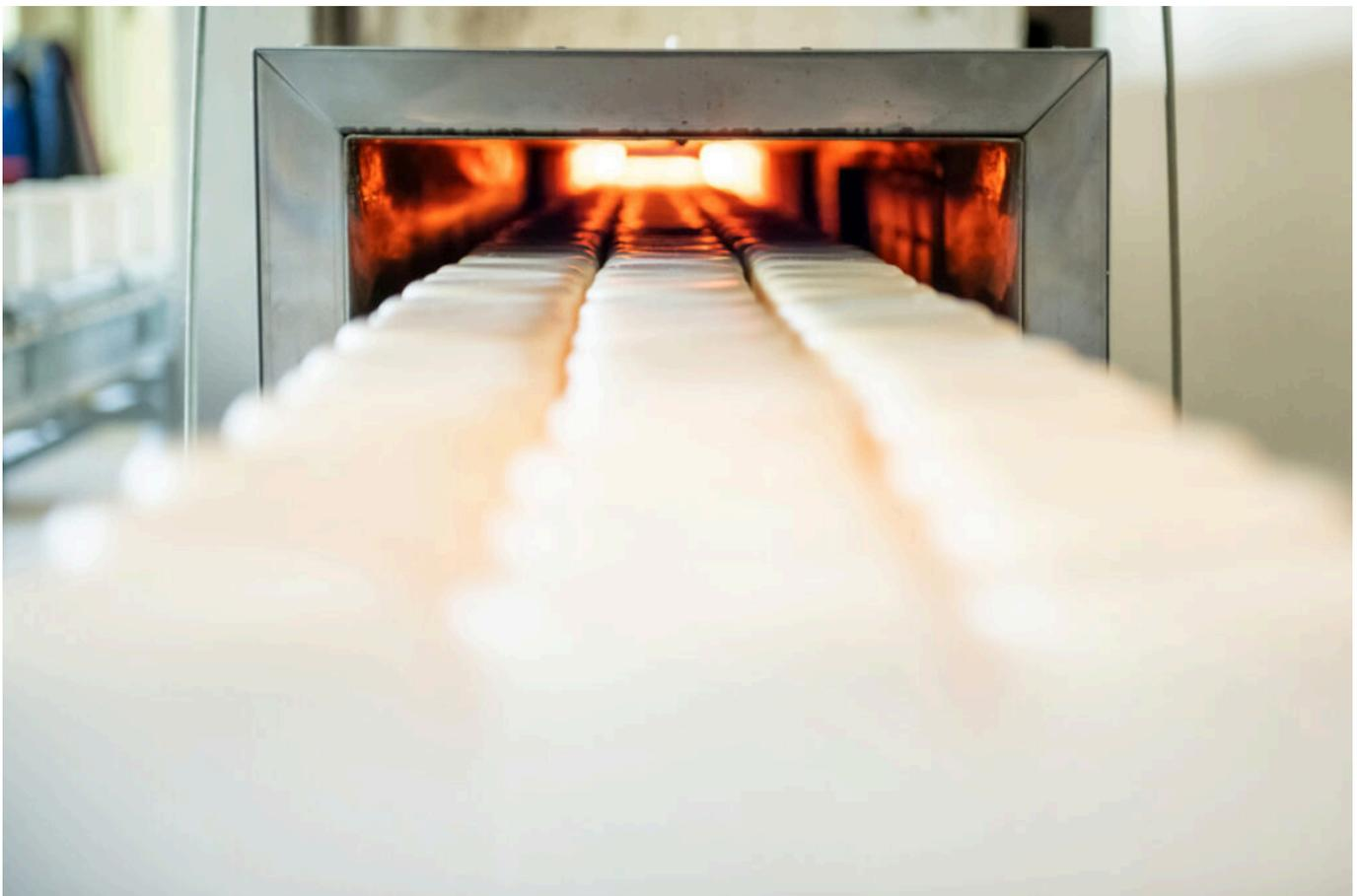
*Glühofen in der Produktion der Leuchtstoffwerk Breitungen GmbH
