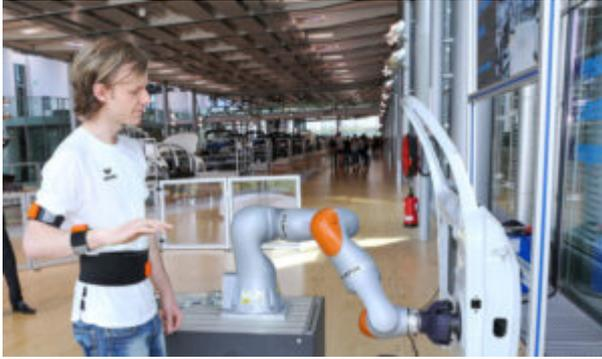
*(Quelle: Wandelbots): Programmieren mittels Sensorjacke oder TracePen: Wandelbots aus Dresden sorgt für mehr digitale Flexibilität im Mittelstand*
