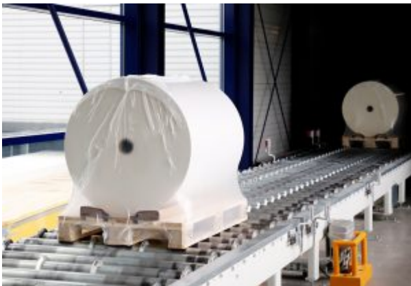
Fertig verpackte Rollen werden per Förderband in die Spedition transportiert
