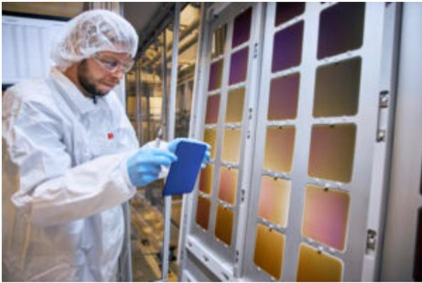
Oxford PV, ein globaler Pionier in der Solartechnologie der nächsten Generation, hat einen neuen Weltrekord im Wirkungsgrad von Solarmodulen aufgestellt. Das 60-Zellen-Modul für Wohngebäude, das mit den Perowskit-Silizium-Tandem-Solarzellen von Oxford PV hergestellt wird, erreicht einen bislang nie dagewesenen Wirkungsgrad von 26,9 % und übertrifft damit die derzeit besten Siliziummodule (~25 %) bei vergleichbarer Modulfläche.
