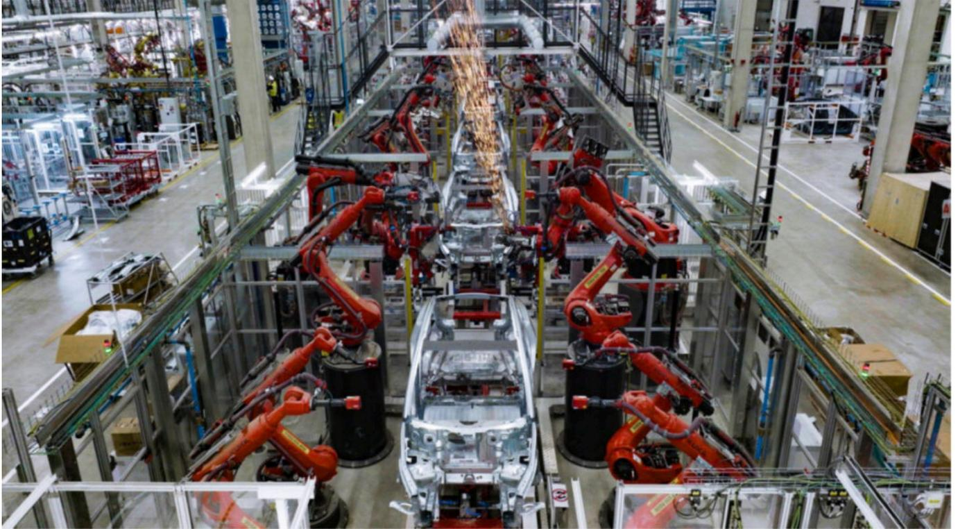
*Tesla in Grünheide – der Karosseriebau. Foto: Tesla*
