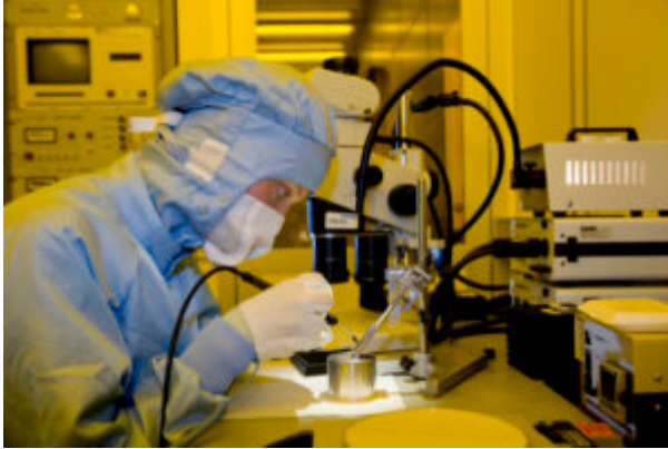
Eine Mikrotechnologin am FBH montiert Laserstacks. Copyright: FBH/schurian.com
