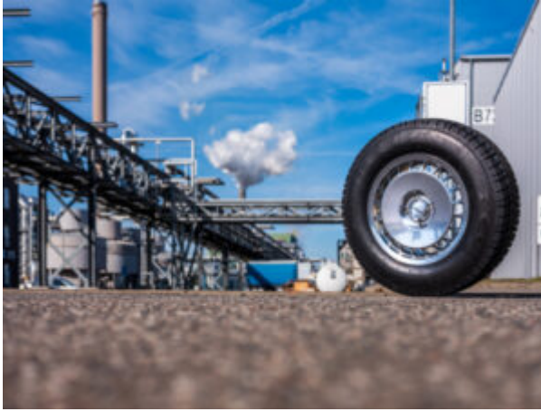
Reifen mit dem naturidentischen, biomimetischen Synthetikgummi BISIKA wurde am Fraunhofer PAZ entwickelt. Copyright: Fraunhofer IAP, Fotograf Till Budde
