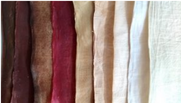
Alternative Werkstoffe auf Basis bakterieller Zellulose werden ggf. die Lederfabrikation als Ergebnis der Massentierhaltung auf ein neues Niveau führen Foto: ScobyTec
