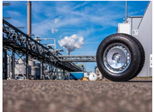
Die Reifen aus Sythesekautschuk haben ein besseres Abriebverhalten
